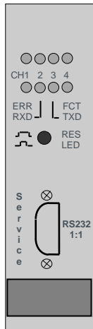
Abbildung 4: Frontplatte des SW2224 mit LEDs, Taster und Service-Schnittstelle
