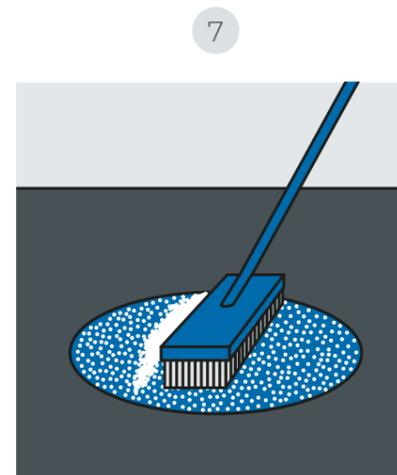
7 SWARCO PREFORMED mit dem Besen reinigen und die Haftung mit einem spitzen Gegenstand prüfen. Schon nach wenigen Minuten ist die Markierung befahrbar.
