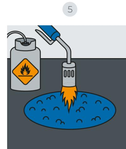
5 SWARCO PREFORMED mit dem Gasbrenner ganzflächig erhitzen – bis zur Blasenbildung an der Oberfläche.
