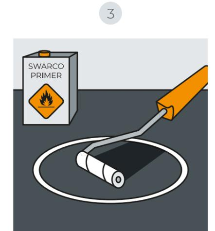
3 Untergrund bei Kälte und Nässe gründlich vorwärmen bzw. vortrocknen. Grundierung auftragen und ablüften lassen.
