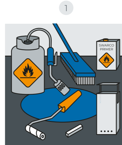
Ausrüstung: Gasbrenner, Besen, Kreide und Nachstreumittel. Bei Bedarf zusätzlich Primer verwenden.
