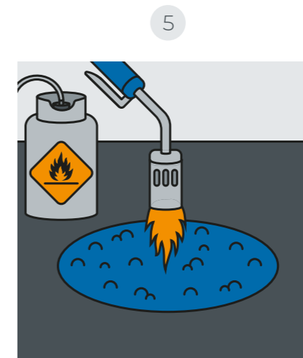
SWARCO PREFORMED Playground mit dem Gasbrenner ganzflächig erhitzen – bis zur Blasenbildung an der Oberfläche.
